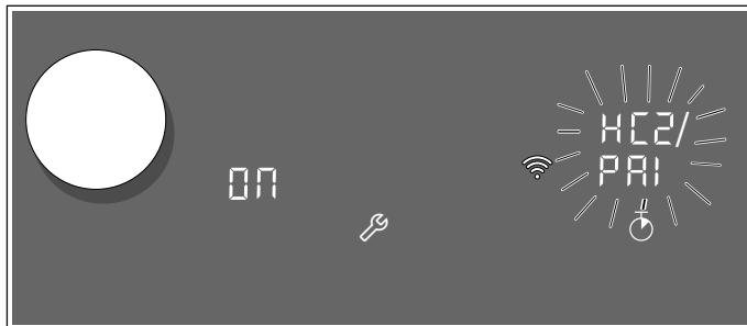
Прибор пытается автоматически установить соединение с приложением. В зоне настройки поочерёдно мигает индикация **HC2 / PRI**. На индикаторе конфорки мигает значение **ON**.
